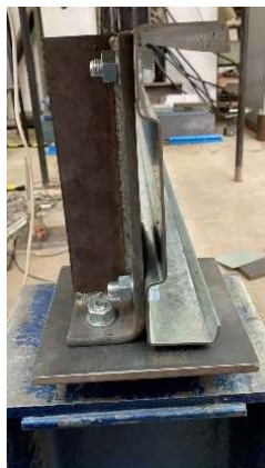
Fig. 4. web crippling test set up
